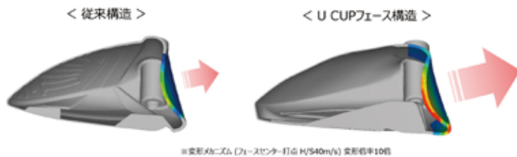
※変形メカニズム(フェースセンター打点 H/540m/s) 変形率半10倍
