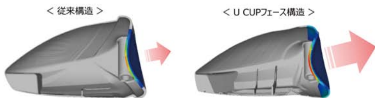
※変形メカニズム (フェースセンター打点 H/540m/s) 変形倍率10倍
